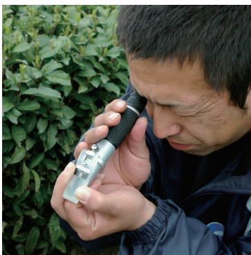
写真4-4 屈折計で測定する [木村信夫撮影]
