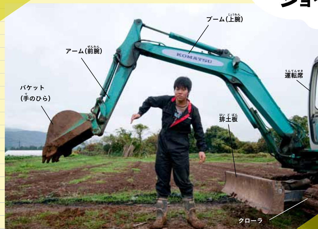
パワーショベルの基本構造。ブーム、アーム、バケットが人間の手のように動く (岡本央撮影、以下表記のないものすべて)
