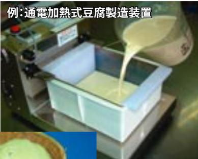
例: 通電加熱式豆腐製造装置
