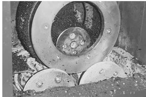
第4図 ディスクベレッター方式の成型機 (ローラー・リングダイ方式)
